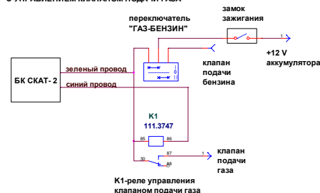
СХЕМА 2 ПОДКЛЮЧЕНИЯ НА КАРБЮРАТОРНЫЙ ДВИГАТЕЛЬ С УПРАВЛЕНИЕМ КЛАПАНОМ ПОДАЧИ ГАЗА
